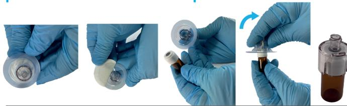
Enlever l'opercule du percuteur  $\varnothing$ 10 mm et fixer le sur la vial  $\varnothing$ 10 mm du primaire. Enlever la protection du percuteur.
