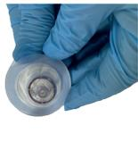
Enlever l'opercule du perceur  $\varnothing$ 20 mm et fixer le sur la vial  $\varnothing$ 20 mm de la base.
