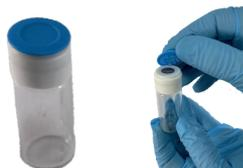
Enlever l'opercule de la vial  $\varnothing$ 20 mm de la base
