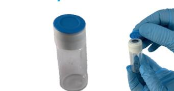
Enlever l'opercule de la vial  $\varnothing$ 20 mm de la base
