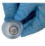
Enlever l'opercule du perceuseur Ø10 mm et fixer le sur la vialie Ø10 mm du durcisseur.
