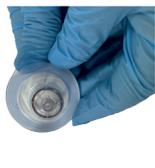
Enlever l'opercule du perceuseur Ø20 mm et fixer le sur la vialie Ø20 mm de la base.
