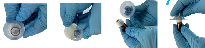
Enlever l'opercule du percuteur  $\varnothing$ 10 mm et fixer le sur la vial  $\varnothing$ 10 mm du durcisseur. Enlever la protection du percuteur.
